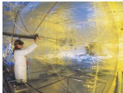
Smogkammer des Labors für Atmosphärenchemie. (c) PSI
